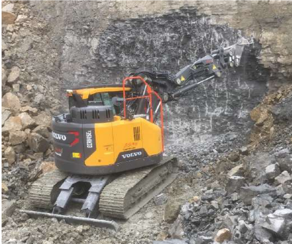
Prototyp Volvo ECR145E als Tunnelversion im Testeinsatz
