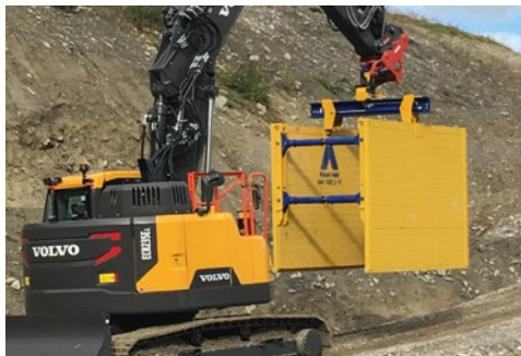
Verbaugreifer mit SBH Verbauelement
