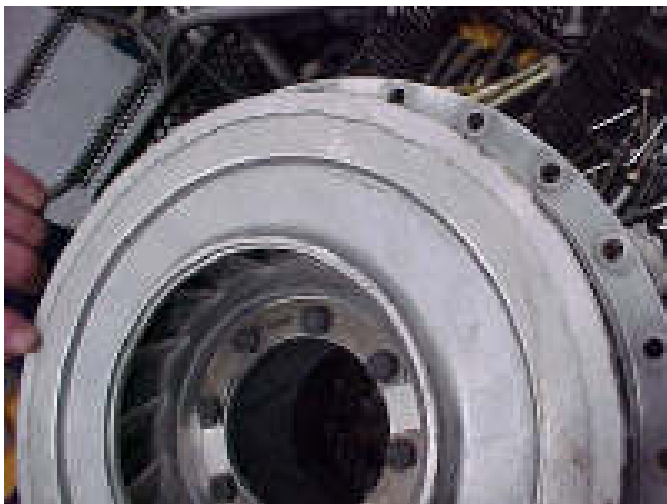
Repariertes Pumpenzahnrad im Wandler.
