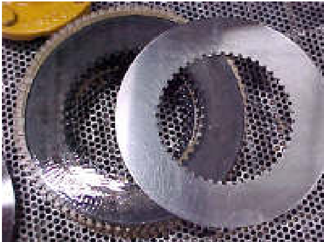
Keine Original-Stahllamellen montiert. Plagiat links. Original rechts.
