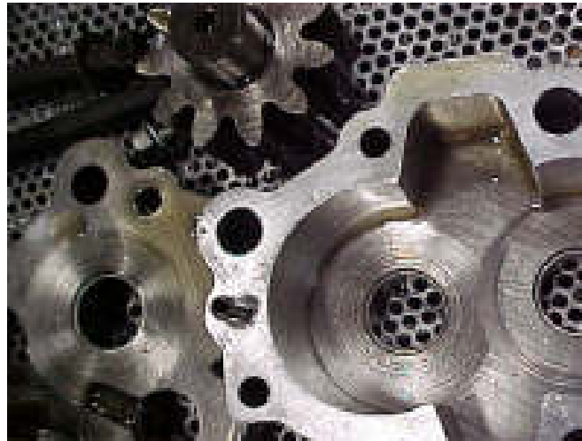
Ölpumpe mit so großem Verschleißschaden, dass CSR sie nicht wiederverwendet hätte.
